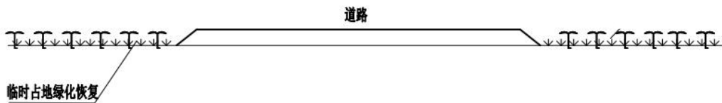
图 5-3 施工检修道路生态恢复措施示意图
